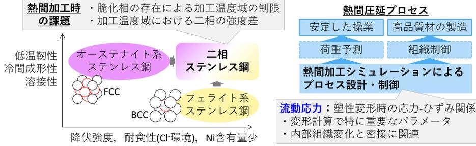
研究目的 フェライト系ステンレス合金の単相域と二相域の熱間流動応力を定式化し、その変形メカニズムを解明する
