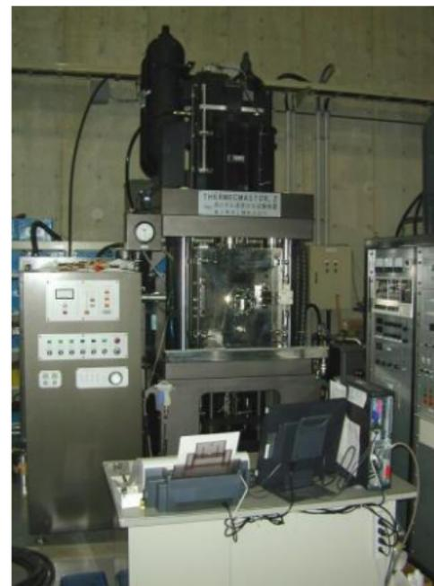
世界最高速の熱間圧縮降伏応力測定装置
