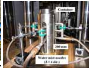
Extrusion mold • Mold material : SKD61 • Lubrication : Glass lubricant • Cooling : Water mist (particle size : 100 \mu m)
