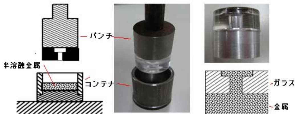
図4 バルクの半熔融金属とバルクのガラスとの接合例
